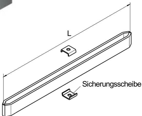
**Fertigkonfektionierte Abhängesysteme verzinkt oder Edelstahl auf Anfrage.
